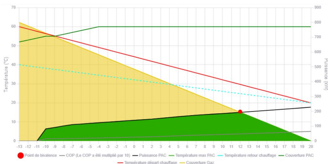
Figure 1 Représentation graphique du fonctionnement de l'installation de chauffage
