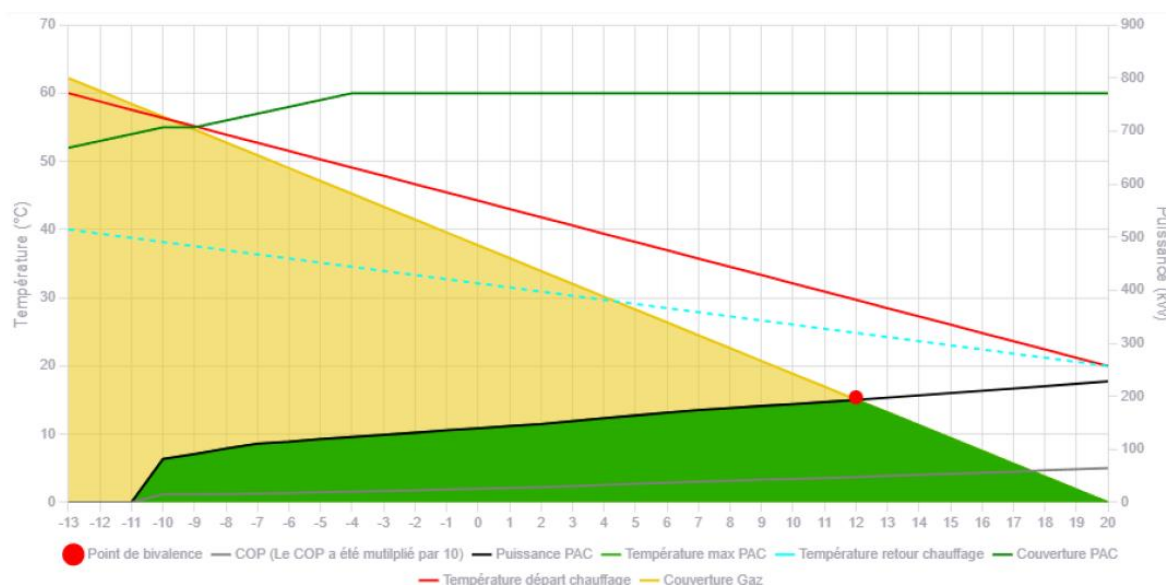
Figure 8 graphique de fonctionnement de la production d'énergie par hybridation PAC + relève gaz (selon étude)
